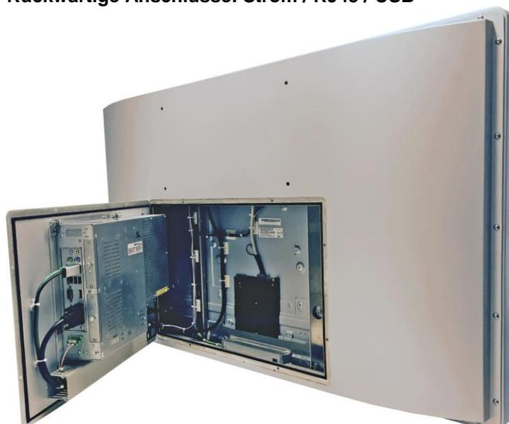
**Serviceklappe – direkter Zugang zum PC
