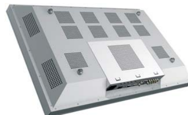
Rechnereinheit wird rückseitig eingeschoben
